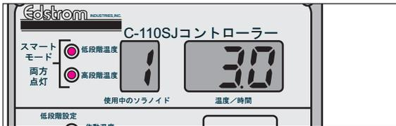
⇒ 電磁弁表示と温度/時間表示に現在の設定値が表示されます。
