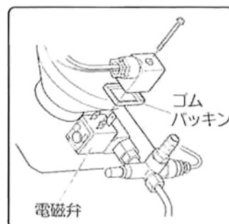
4. 本体の電磁弁に端子ソケットを差し込み、ネジで固定してください。
