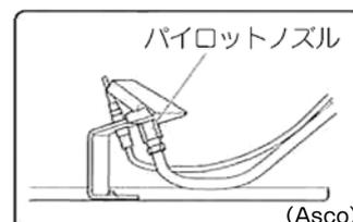
2.底面の蝶ネジを外し、パイロットフレームガイドをスライドさせて抜き取ります。必要に応じてパイロットフレームガイドを立て、パイロットノズルを針などで清掃してください。
