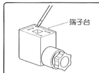
2. 電磁弁用電源線およびアース線を、右図のように端子台の端子に差し込み、側面のネジで固定してください。（電線に極性はありません。）
