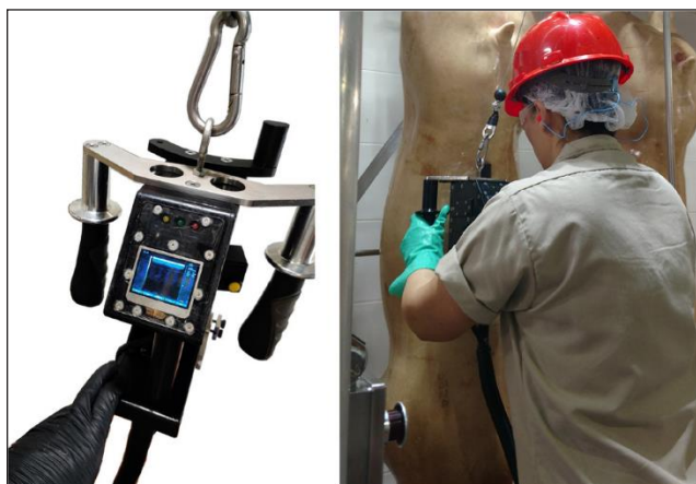
図 1.7 超音波枝肉測定装置
